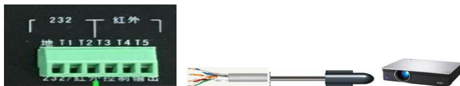
中控 6 位绿色端子 (配件) 网线 红外发射管 (配件) 投影机
